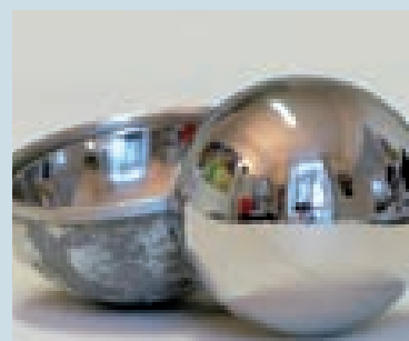
Abb. 6: Das Explantat mit deutlich sichtbarer zirkumferenter Abrieblinie auf der Kappe
