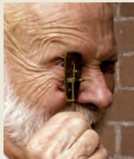
Abb. 3: Replika eines Mikroskops von Antony van Leeuwenhoek (etwa 1660). Zwischen zwei dünnen Messingplatten ist eine kleine Linse gefasst. Davor befindet sich ein Dorn, auf den das Untersuchungsobjekt gespießt wurde. Es wurde durch das Drehen an den Gewindestangen in den Betrachtungsabstand gebracht, der eine Scharfstellung ermöglichte
