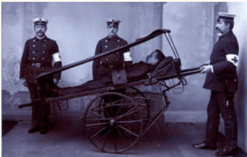
Die Altonaer Räderbahre wurde vom Stabsarzt Dr. Soltsien der „Altona-Ottensener Colonne des Rothen Kreuzes“ entwickelt. Damals revolutionierte dieses Fuhrwerk den Krankentransport durch seine einfache zusammenklappbare, stabile Konstruktion, die Bedienung durch ein bis zwei Mann und einen schonenden Transport für eine längere Zeit. Soltsien präsentierte seine Innovation 1893 auf der vom italienischen Roten Kreuz organisierten internationalen Ausstellung in Rom
