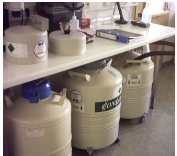
Abb. 2: Unterschiedliche Kryobehälter für nicht-infektiöse und potenziell infektiöse Keimzellen (Ejakulat, Oozyten, befruchtete Oozyten im Vorkernstadium)
